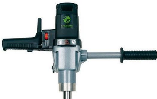
**Дрель Eibenstock EHB 32/4.2 предназначена для сверления отверстий диаметром до 32 мм, имеет мощный электродвигатель (1,7 кВт).** Двигатель надежно защищен от перегрузки и перегрева, а также имеет быстроменяемые угольные щетки. Дрель оснащена 4-х скоростной коробкой передач, с возможностью плавного изменения частоты вращения. Выбор скорости производится селекторами-переключателями специальной формы со стопорами.
